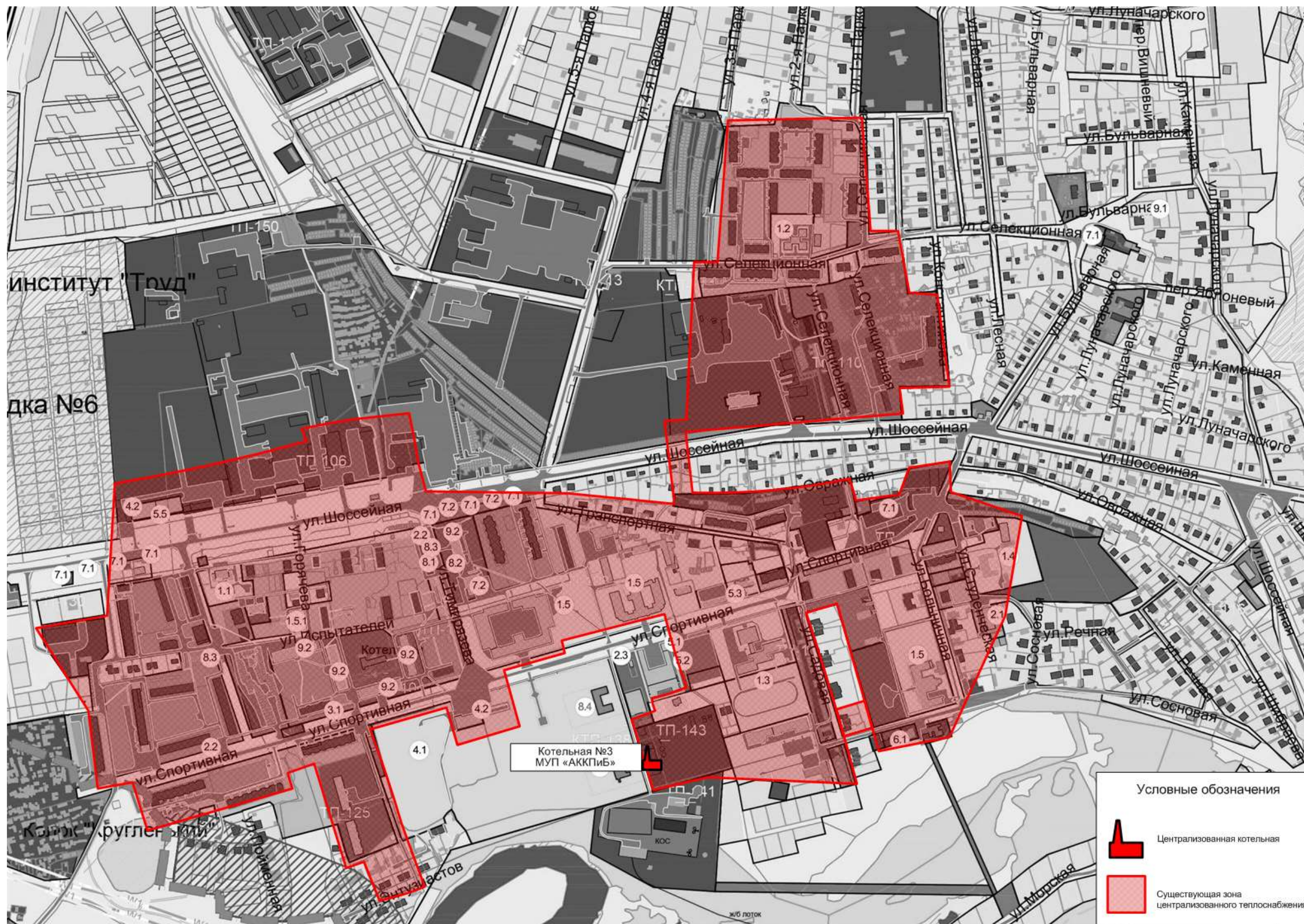
Рисунок 7 – Зона действия централизованной системы теплоснабжения п.г.т. Усть-Кинельский
